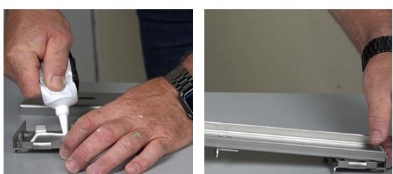
Aplicar el adhesivo M1 provisto en el interior de cada extremo. Luego colocar el extremo en la parte inferior de cada extremo del marco de inserción de azulejos. Asegurarse de que el extremo esté completamente ajustado contra el marco en todos los lados. Sujetar el extremo en su lugar para evitar movimientos. Dejar secar al menos 24 horas antes de manipular.
